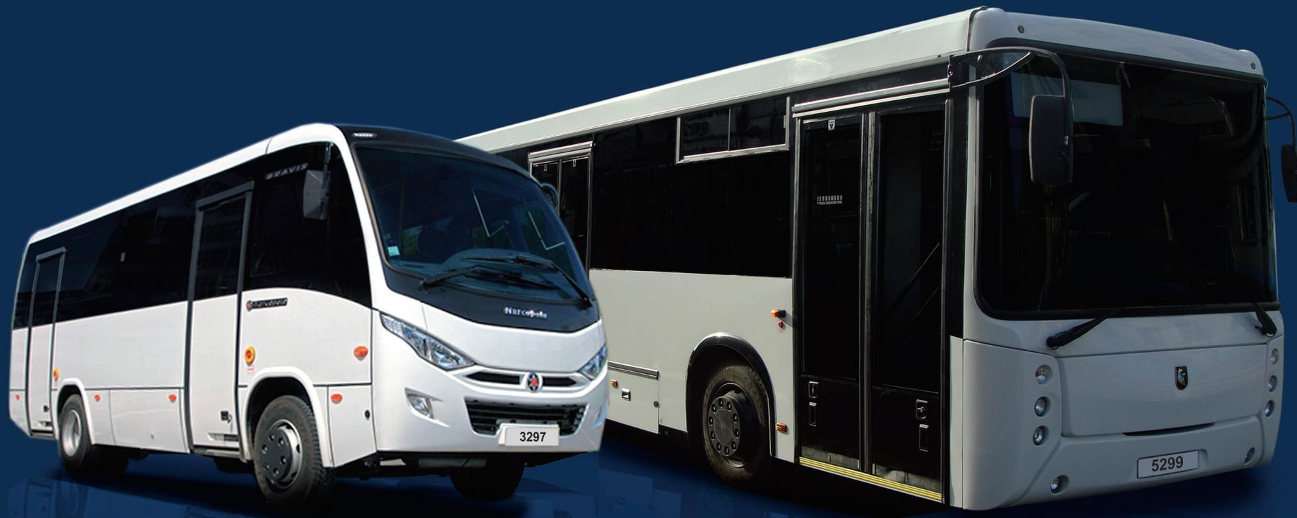
Налажен выпуск автобусов на сжатом природном газе. Цена метана более чем в 2 раза ниже стоимости дизельного топлива. Это дает возможность существенно снижать эксплуатационные затраты. Газовый двигатель имеет сниженный уровень токсичных веществ в выхлопных газах (соответствует Евро-5), а также сниженный уровень шумнос-
