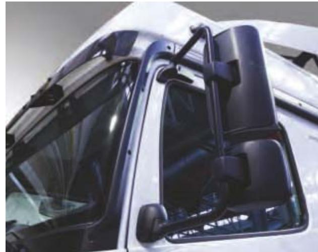
Зеркало для обзора тротуара, зеркало для контроля «слепой зоны» и система обогрева зеркал для обеспечения безопасности движения.
