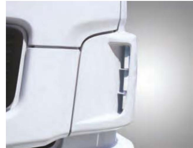
Дефлектор, направляющий поток воздуха ниже ручек дверей, сохраняет их чистоту даже в слякотную, дождливую погоду.
