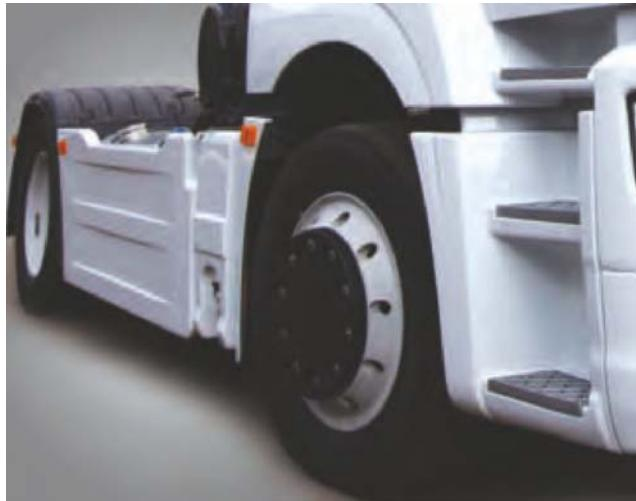
Боковые обтекатели шасси оптимизируют воздушный поток. Улучшенная аэродинамика снижает расход топлива.
