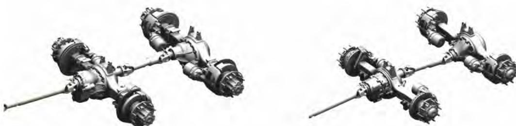
На автомобилях КАМАЗ-65206 устанавливается tandem ведущих мостов Daimler HD4/HL4 или Dana DD150/R150 (в зависимости от комплектации) с гипоидной главной передачей. Грузоподъемность tandem'a до 19т.
