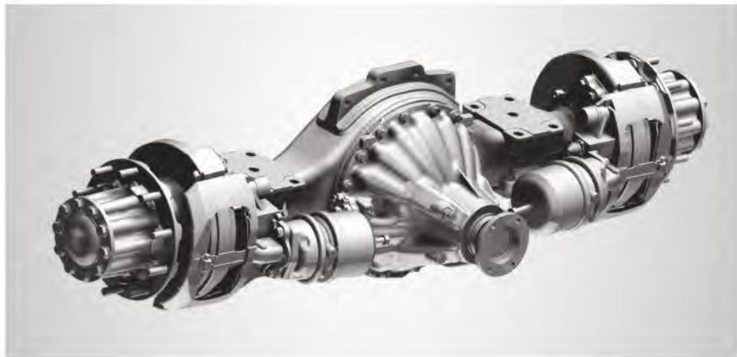
На магистральный тягач КАМАЗ-5490 установлен одноступенчатый мост HL6 с гипоидной главной передачей. Эффективная передача тягового усилия увеличивает экономичность.
